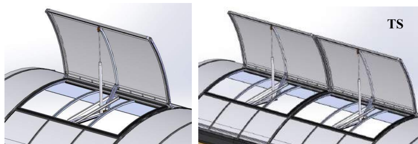
Рис. 5 Возможное расположение одинарной створки для противодымной и естественной вентиляции
