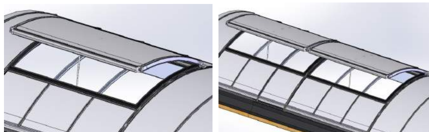
Рис. 3 Возможное расположение одинарной створки для естественной вентиляции
